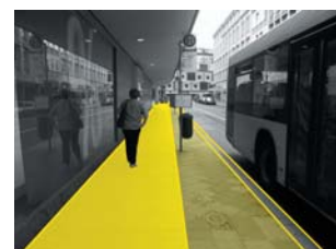
Münzstraße, C&A Einengung des Fußgänger- bereiches durch die Aufstellfläche der Haltestelle, optimale Einbindung des vorhandenen Vordaches
